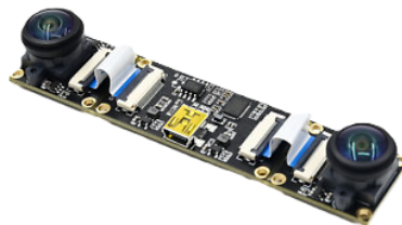
Figura 2.7: Imagen de la cámara GXIVISION-LSM22100
