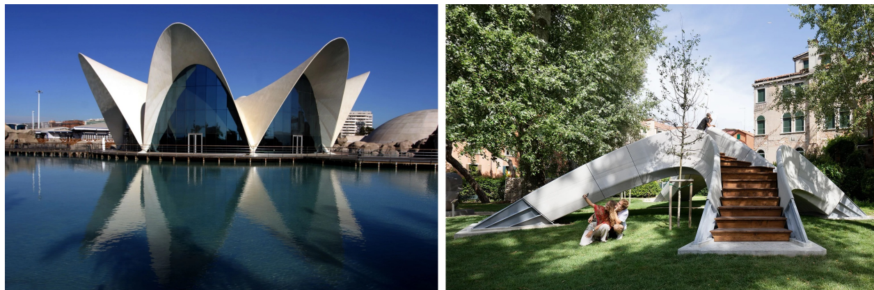
Figura 1.1: Láminas funiculares, ayer y hoy. Izquierda: el restaurante del Oceanogràfic de Valencia, con los paraboloides hiperbólicos característicos de Félix Candela, uno de sus últimos diseños. Derecha: el puente Striatum en Venecia (Block Research Group y Zaha Hadid Architects), impreso en 3D y sin armadura. En ambos casos la eficiencia estructural precede de la forma.
