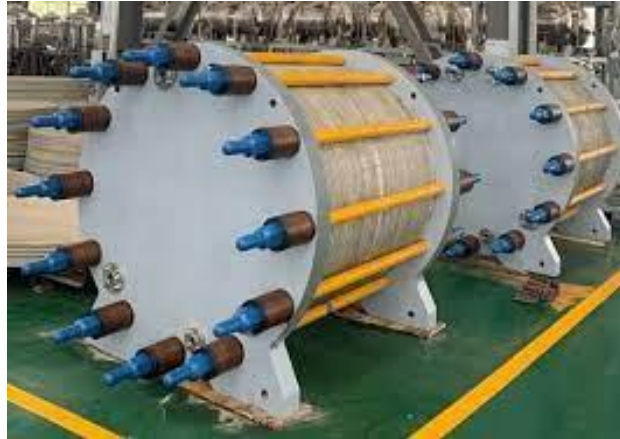
Ilustración 4. Electrolizador alcalino. Fuente: John Cockeril.
